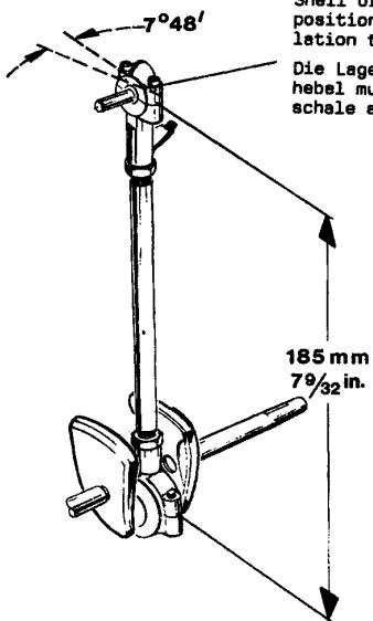
**NEEDLE BAR, NEEDLE LEVER, CRANK SHAFT, HANDWHEEL**
