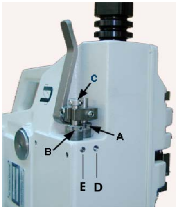
LOCATION OF LIMIT SCREWS AND LOCK NUTS FOR CHAINING SECTION AND PRESSER FOOT SETTING. POSITION DER ANSCHLAGSCHRAUBEN UND KONTERMUTTERN FÜR KETTENTEIL UND DRÜCKERFUSS.
