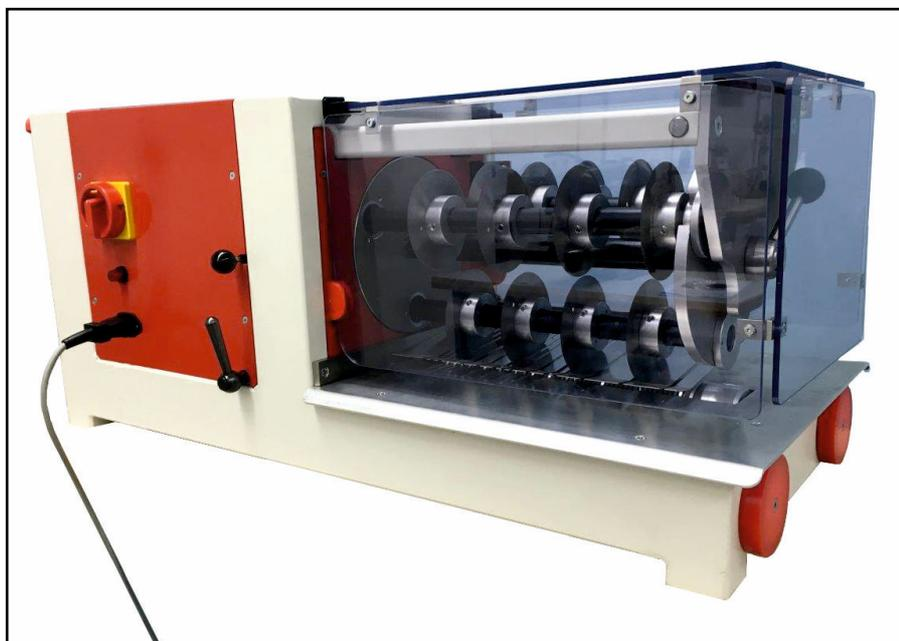
Die Schneidemaschine hat eine **drehbare Messertrommel** mit 3 Messerwellen. Jede Messerwelle ist mit 4 freischneidenden Rundmessern bestückt. In Standardausführung sind diese Messer je Welle auf 60, 70 und 80 mm eingestellt (andere Abmessungen auf Wunsch). Die Unterwelle ist mit einer 5 mm Teilung versehen.
